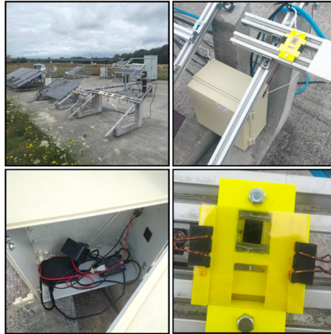
Figure 2: Banc de caractérisation outdoor au SIRT
